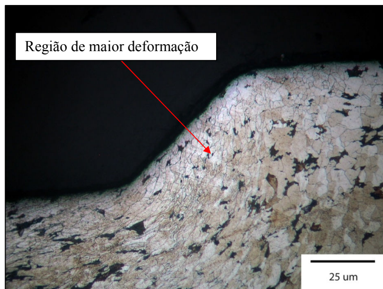
Figura 55 – Aço SAE 1020, ângulo de extrusão de 60°. Ataque Nital 2%.
