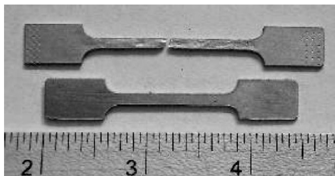
Figura 2 – Corpo de prova pequeno utilizado no ensaio de tração.
