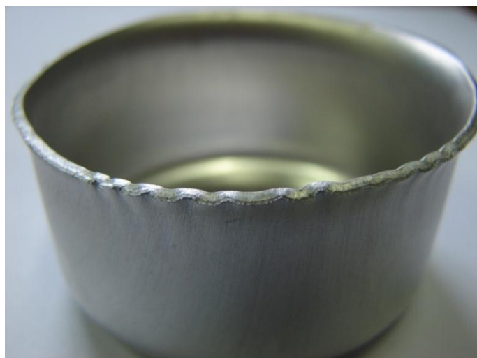
Figura 54. Peça que foi estampada com uma folha de teflon e com as matrizes lixadas a 1200.
