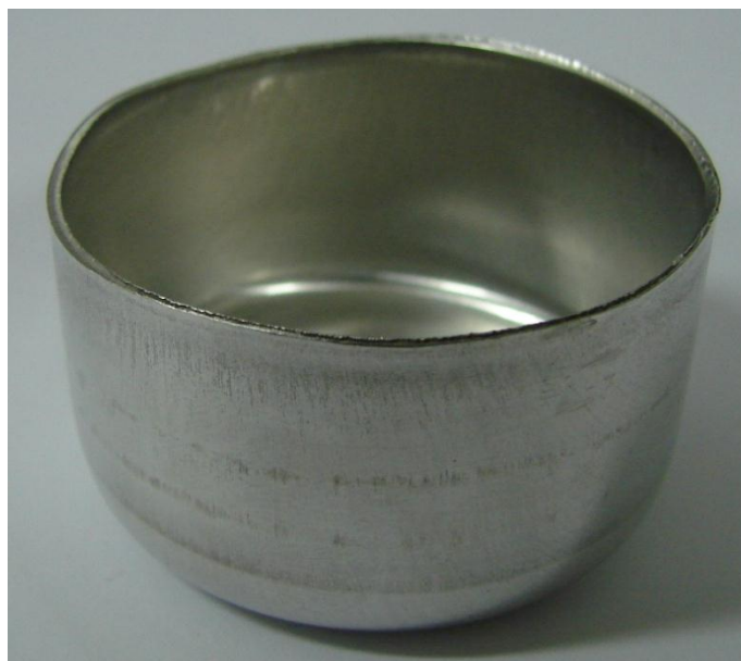
Figura 53. Peça estampada ao qual não apresentou enrugamento.
