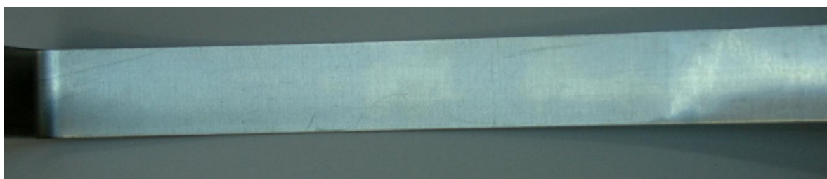
Figura 60. Ausência de marcações na chapa durante o ensaio DST com o pino livre.
