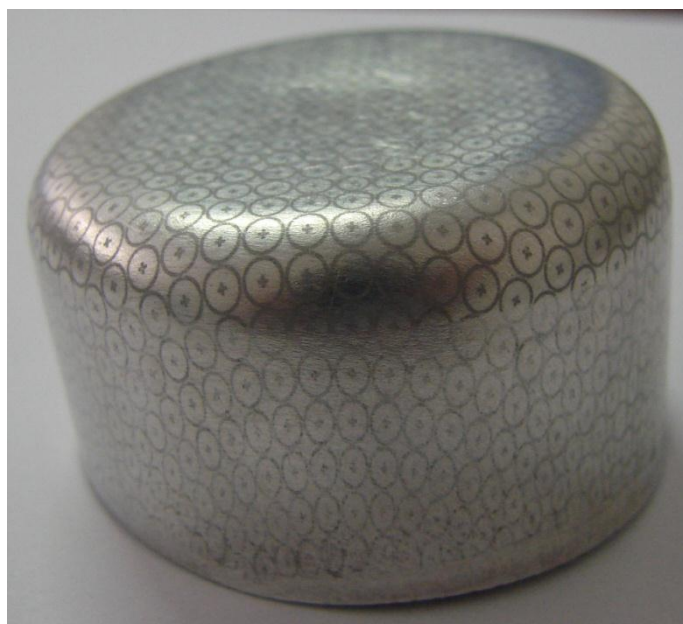
Figura 56. Gravação eletroquímica de uma malha circular para medir as deformações.
