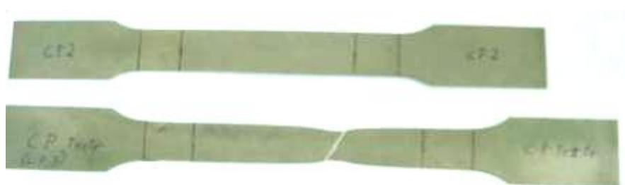
Figura 3.5. Fratura dútil da chapa (sentido de laminação paralelo ao corpo de prova), caracterizada pelo ângulo de ruptura (aprox. 45°) e pela estricção visível.
