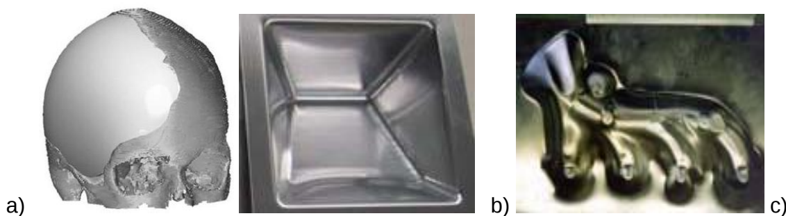
Figura 1.1. Aplicações da estampagem incremental: a) implante craniano (Bazan 2004), b) fogão solar e c) protótipo de coletor de admissão (Jeswiet 2004)
