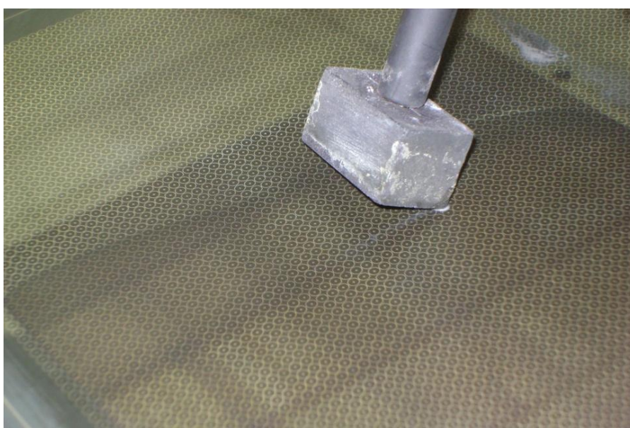
Figura 4.19. Gravação dos círculos para exame de visioplasticidade
