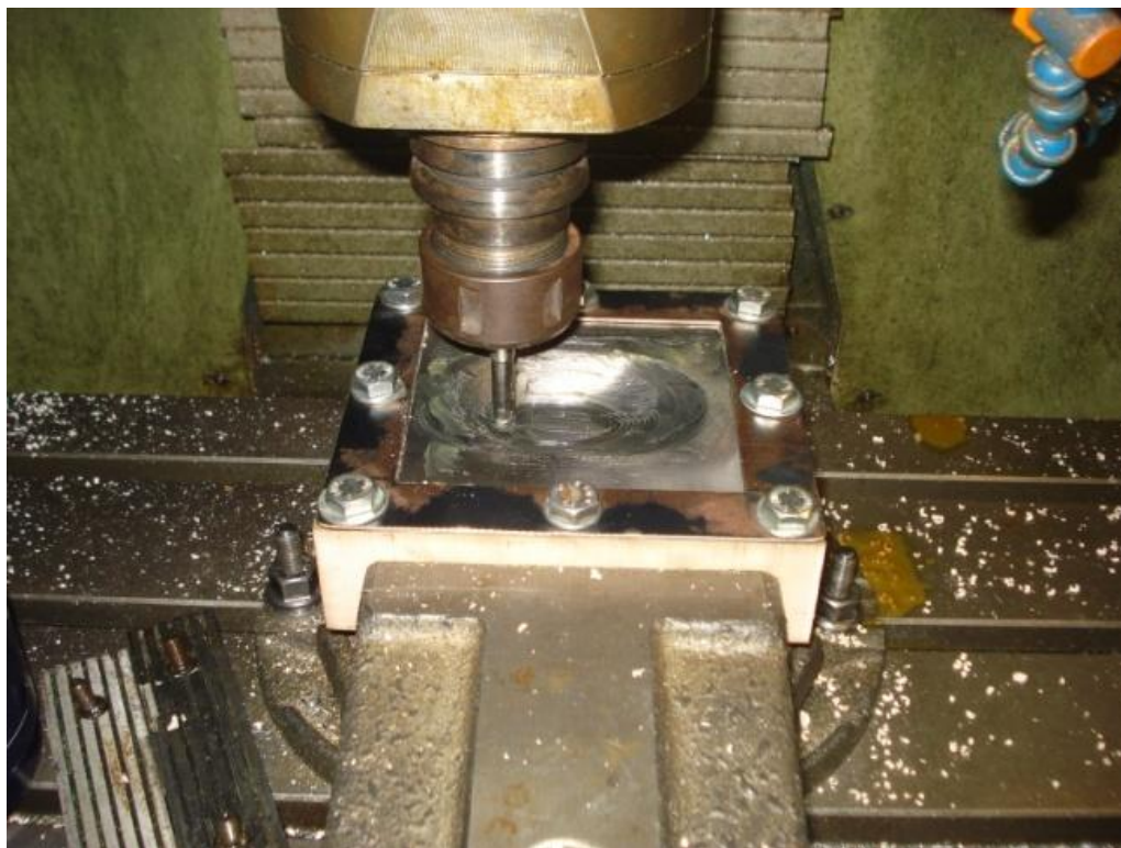
Figura 4.10. Estampagem da chapa de alumínio, utilizando o polímero usinado anteriormente como ponto de apoio inferior
