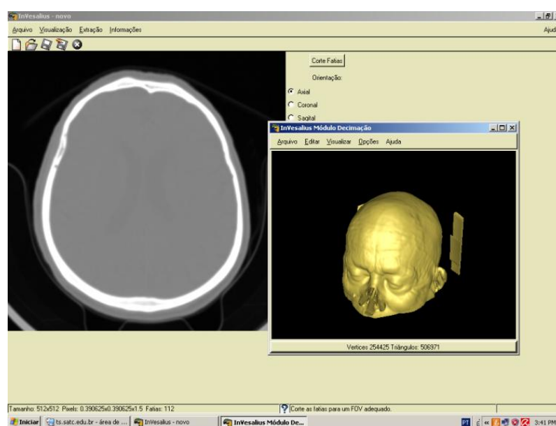
Figura 4.5. Imagens JPG (pictoriais) de tomografia axial, lateral e coronal e o modelo vetorial 3D gerado
