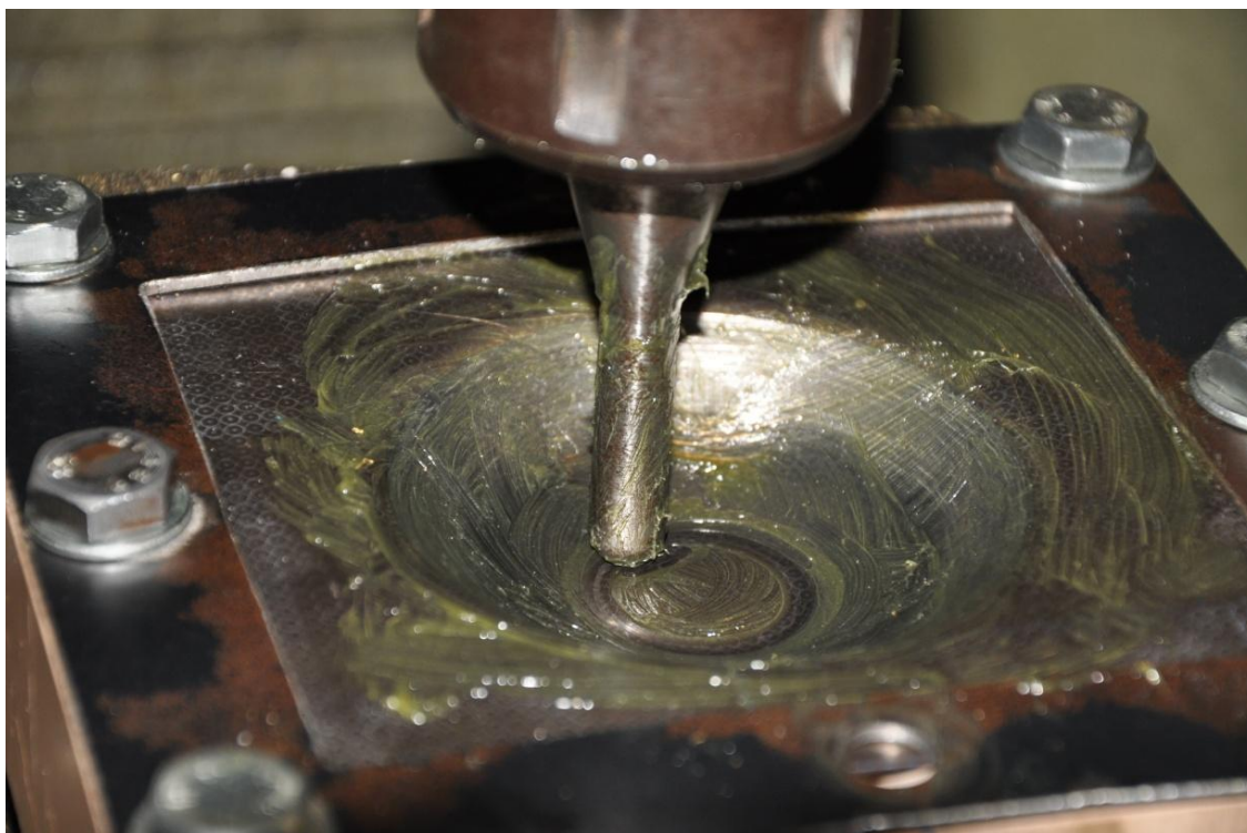
Figura 4.11. Lubrificação no processo de estampagem incremental
