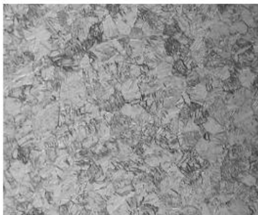
Figura 2.1. Micrografia óptica da superfície do Titânio comercialmente puro (99%) laminado, com grãos \alpha – aumento de 200x;
