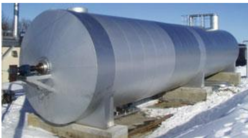
Figura 2.14 – Biorreator fluxo em pistão ou pistonado horizontal (SCHMIDT, 1998).
