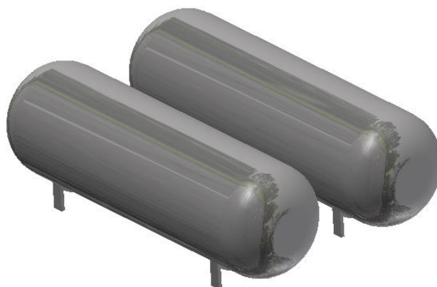
Figura 4.36 – Gasômetros da planta de biogás.
