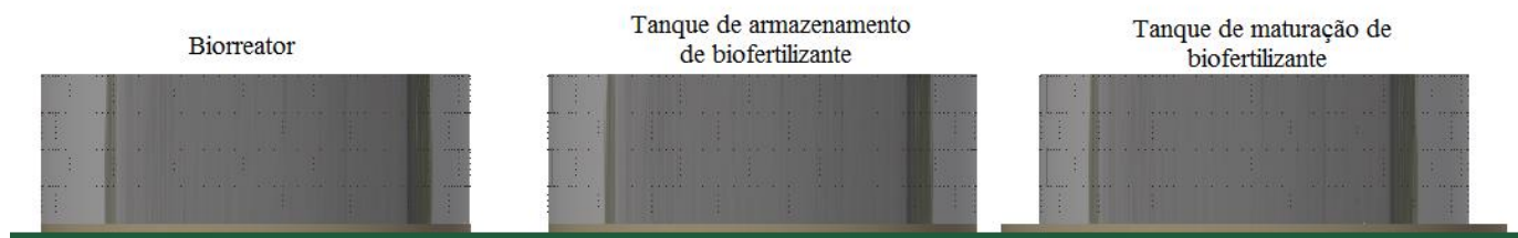
Figura 4.52 – Disposição em linha dos tanques e biorreatores na planta de biogás.
