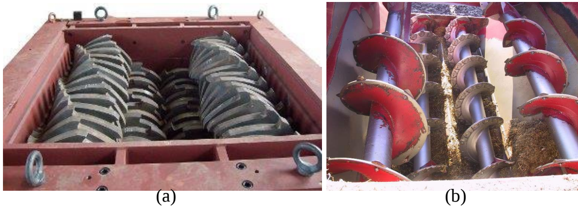
Figura 2.7 – (a) Fragmentador de substrato; (b) Transportador de rosca. (BAIER, 2013).
