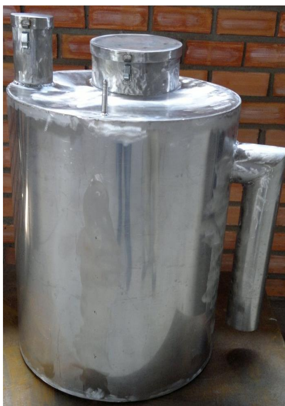
Figura 2.21 – Modelagem de biorreator em chapas de aço inox (BORBA, 2013).
