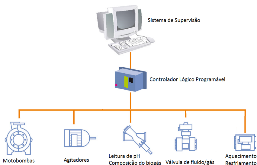
Figura 3.27 – Diagrama do planejamento de uma planta de biogás (SCHIEVANO et al. , 2011).
