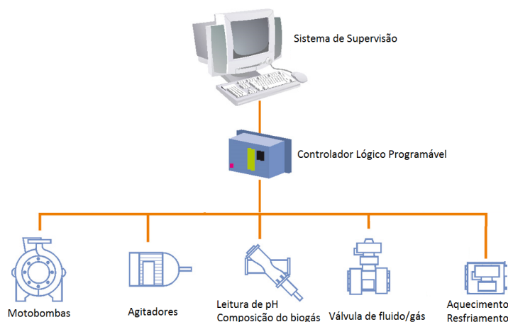
Figura 4.38 – Hierarquia dos níveis de automação da planta.
