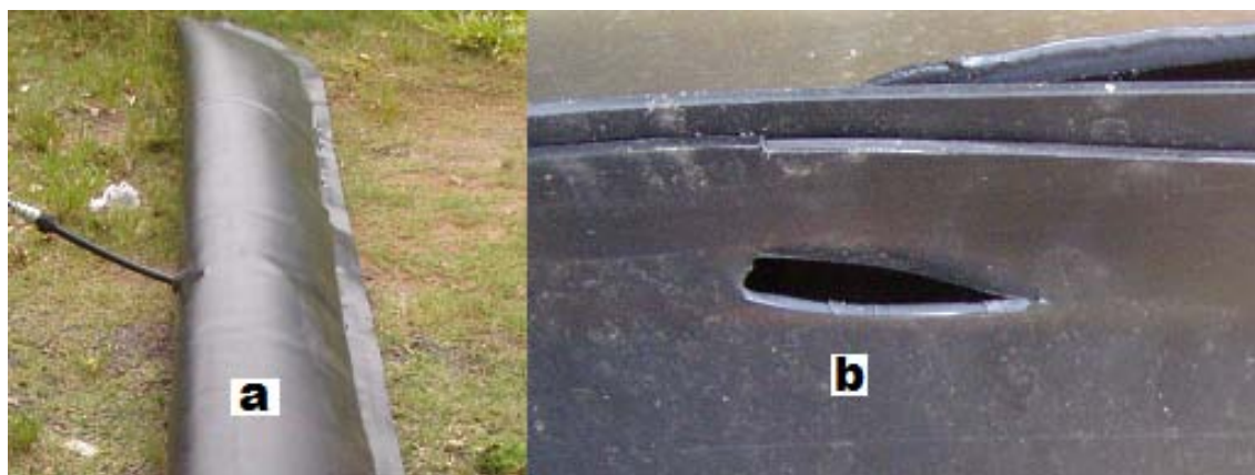
Figura 6 – Ensaio mecânico em balões de PEAD (Polietileno de Alta Densidade) 3mm a – ensaio de resistência mecânica; b – ruptura causada por pressão de 2,103bar.
