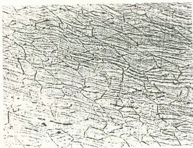
Figura 4.15. Microestrutura do aço inoxidável austenítico 304, deformado a 100 °C ( \phi = 0,7 ) com alta velocidade de deformação ( \dot{\phi} = 10,0 \text{ s}^{-1} ).
