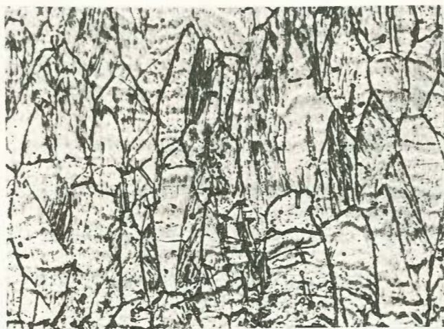
Figura 4.18. Microestrutura do aço inoxidável austenítico 304, deformado a 300 °C ( \varphi = 0,7 ) com alta velocidade de deformação ( \dot{\varphi} = 10,0 \text{ s}^{-1} ).
