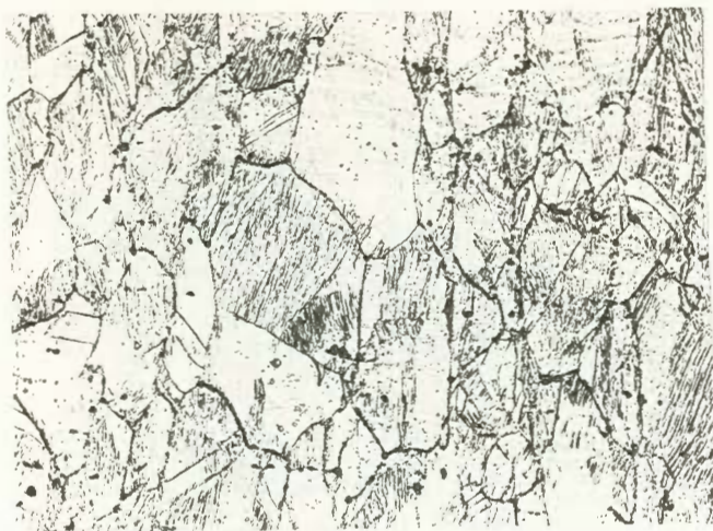
Figura 4.14. Microestrutura do aço inoxidável austenítico 304, deformado a 100 °C ( \phi = 0,7 ) com baixa velocidade de deformação ( \dot{\phi} = 0,1 \text{ s}^{-1} ).
