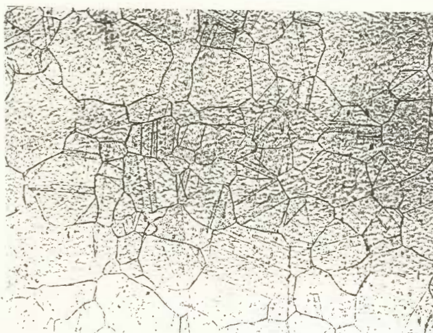
Figura 4.1. Microestrutura do aço inoxidável da série 304 solubilizado (corte transversal). Ácido acético 10% x 100.
