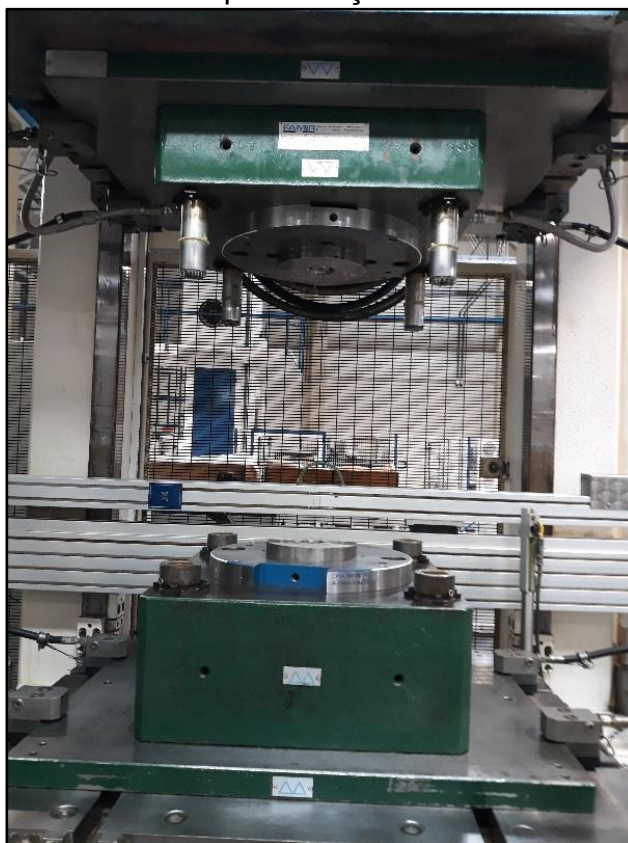
Figura 77 – Fixação da Matriz e Prensa Chapas no Porta Ferramental– Ensaio Múltiplos Punções
