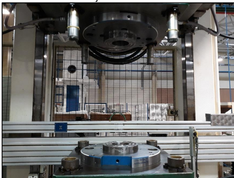
Figura 80 – Fixação da Matriz e Prensa Chapas no Porta Ferramental – Ensaio Nakajima Modificado
