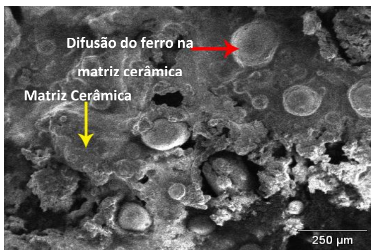
Figura 81 - Micrografia do CCM com magnitude de 100X
