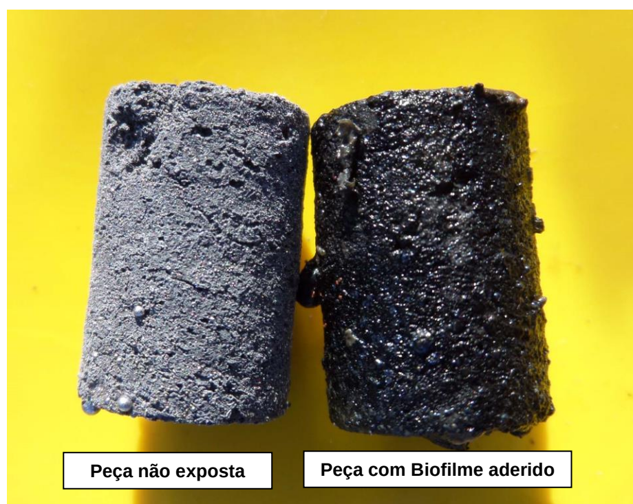
Figura 84 - Corpos de prova sem deposição e com deposição de biofilme.
