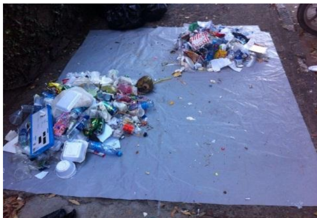
Figura 2: Técnica de Quarteamento dos Resíduos Sólidos (ABNT 10.007/04).
