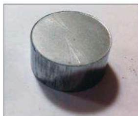
Fig. 5: Amostra compactada e sinterizada de ligas de BiSb obtidas no LdTM/UFRGS
