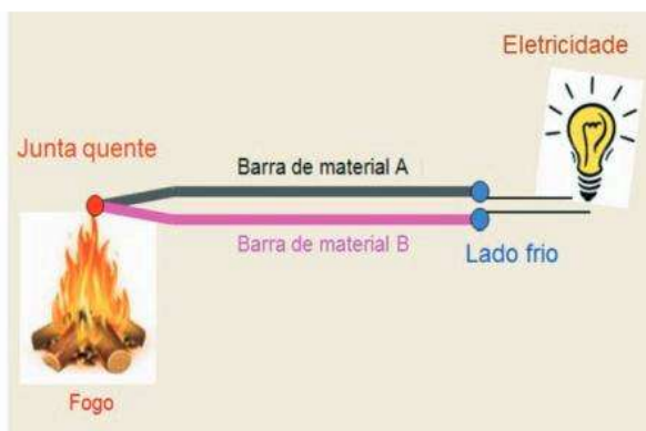
Fig. 1: Forma simplificada da demonstração do "Efeito Seebeck"
