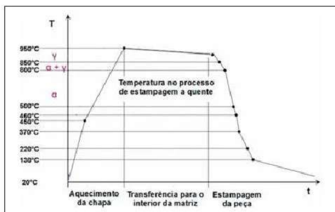
Figura 2 - Ciclo térmico no processo de estampagem a quente. Fonte: Neugebauer 2011
