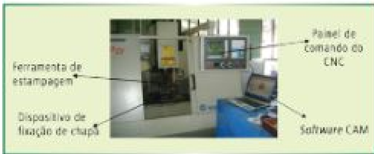
Fig. 9 – Máquina e recursos usados nos testes práticos
