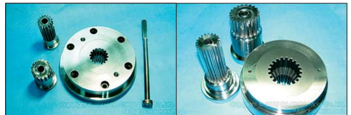
Figura 8 - Punções e matrizes de compactação com alta complexidade [36]
