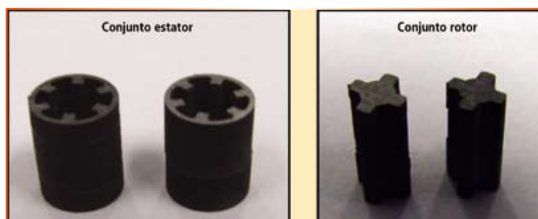
Fig. 10 – Conjunto rotor e estator obtido pelo processo de corte por eletroerosão a fio
