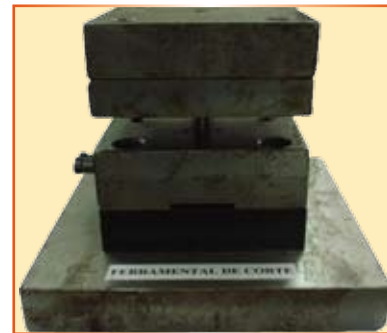
Fig. 2 – Ferramental de corte empregado no corte do rotor e do estator
