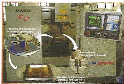
Fig. 7 – Equipamento CNC adaptado para o processo de estampagem incremental (9)
