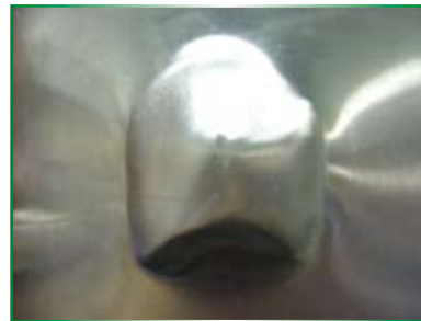
Fig. 10 – Protótipo do implante de reconstrução de osso frontal e órbita confeccionado em alumínio pelo processo de estampagem incremental
