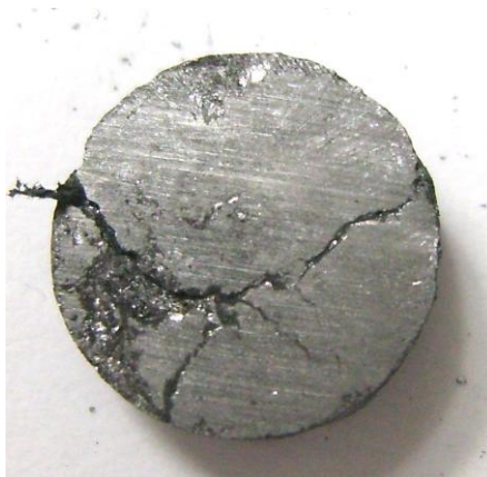
Fig. 5. Amostra ( \varnothing 9mm) obtida pela compactação a quente e sinterização dos resíduos dos MTs. Escala: 5:1.
