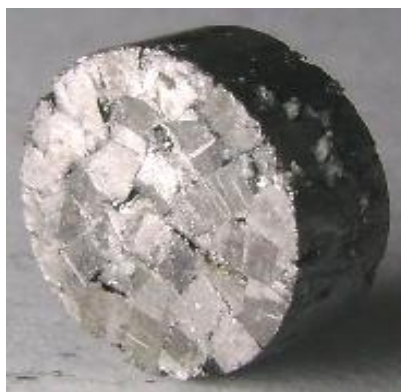
Fig. 4. Amostra ( \varnothing 9mm) obtida pela compactação e sinterização a frio dos resíduos dos MTs. Escala: 5:1.
