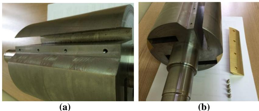
**Figura 8 – Usinagem (eletroerosão a fio) e confecção das cavidades dos ímãs – (a) Detalhe da cavidade – (b) tira de latão para prender os ímãs**
