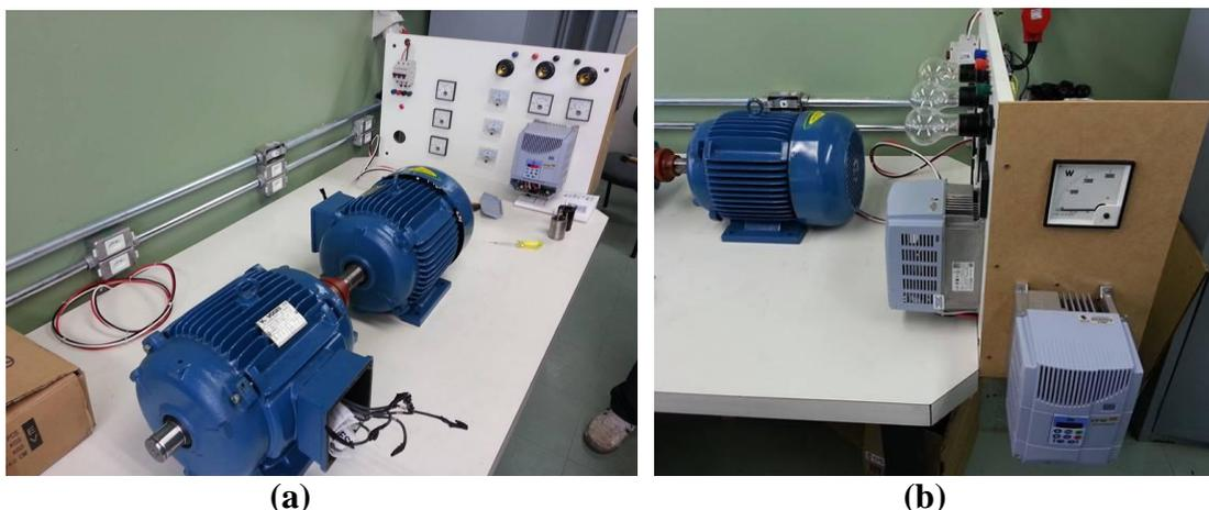
**Figura 13 – Bancada de Testes do Gerador Trifásico ou Máquina desenvolvida neste projeto – (a) Vista geral com as máquinas – (b) Detalhe da vista lateral**
