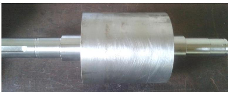
**Figura 7 – Blocos usinados e inseridos no eixo da máquina**
