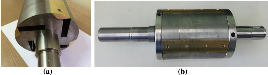
**Figura 9 – Máquina montada – (a) Detalhe da fixação das tiras de latão – (b) Detalhe de fixação dos discos de aço inoxidável nas extremidades**
