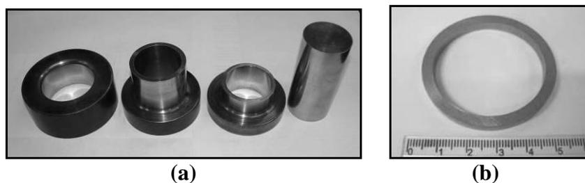
**Figura 3 – Amostras na forma de anel – (a) Matriz – (b) Corpo de Prova**
