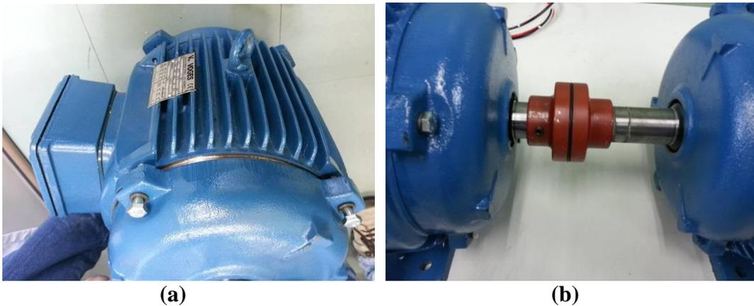
**Figura 11 – (a) Máquina sendo fechada com a colocação dos parafusos – (b) Acoplamento das duas máquinas**
