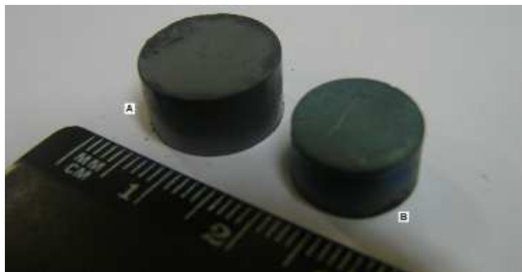
Figura 12 - (A) amostra à verde - B( amostra de WC-6Co-Cr sinterizada à 1450°C
