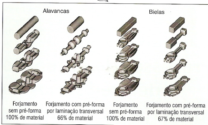
Figura 2 - Economia de material que pode ser obtida com o uso de pré-formas no forjamento de alavancas e bielas [1]
