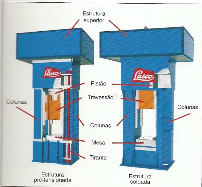
Figura 4 - Tipos de estruturas das prensas hidráulicas e principais componentes
