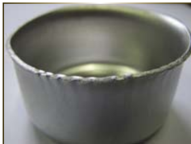
Fig. 11 – Peça estampada com uma folha de Teflon e acabamento das matrizes com lixa 1.200
