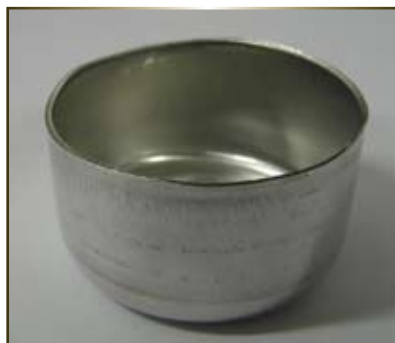
Fig. 10 – Peça estampada sem enrugamento
