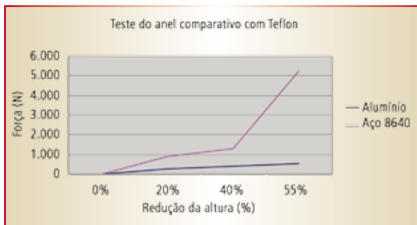
Fig. 24 – Resultados do teste do anel para variação da força x altura
