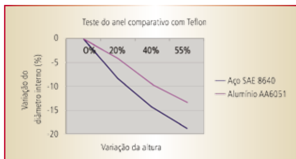
Fig. 16 – Resultados do teste do anel para variação do diâmetro x altura
