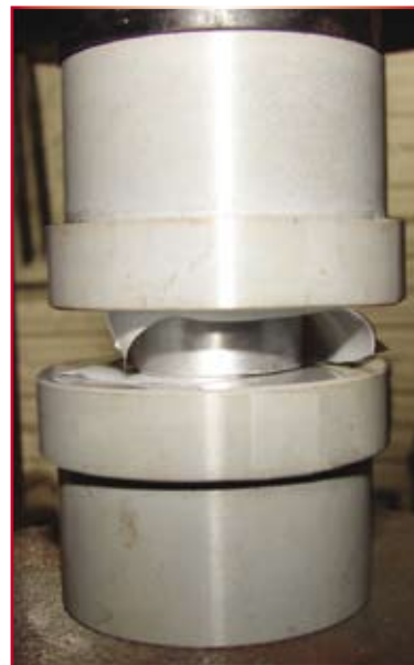
Fig. 12 – Corpo-de-prova entre as bases
