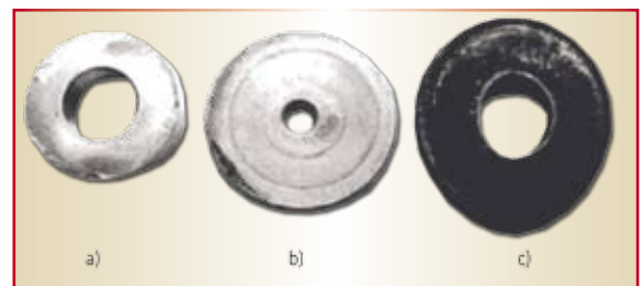
Fig. 6 – Anéis deformados em ensaio de compressão (2)
