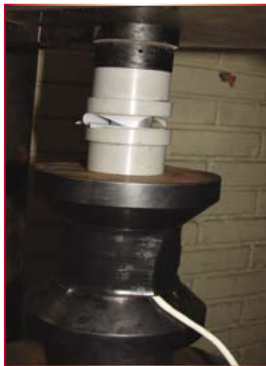
Fig. 11 – Bases cerâmicas sobre a célula de carga
