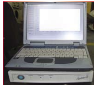
Fig. 10 - Sistema de aquisição de dados Spyder 8, com o software Catman Express 3.1
