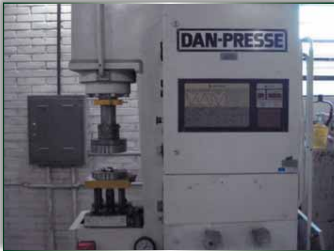
Fig. 8 – Máquina Dan-Pressa para a realização do ensaio Nakazima
