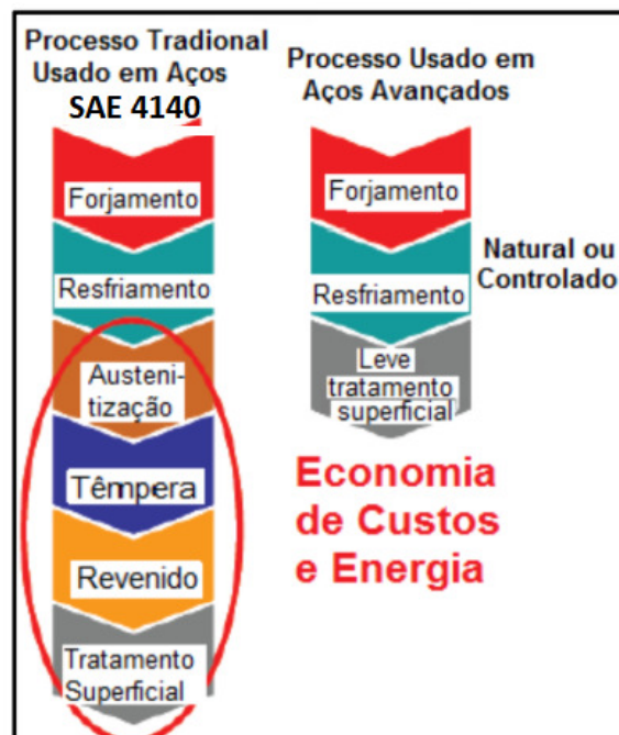
Figura 1- Fluxograma Tratamento Térmico do aço SAE 4140 e aço Bainítico (AHSS)
