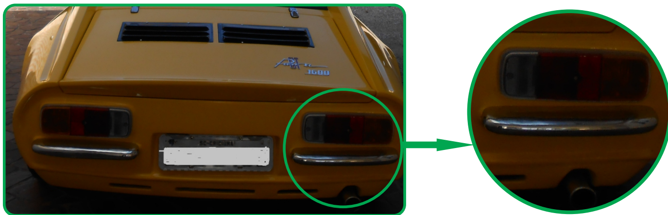
Detalhe de um para-choque a ser restaurado ( Puma GT 1600 )
