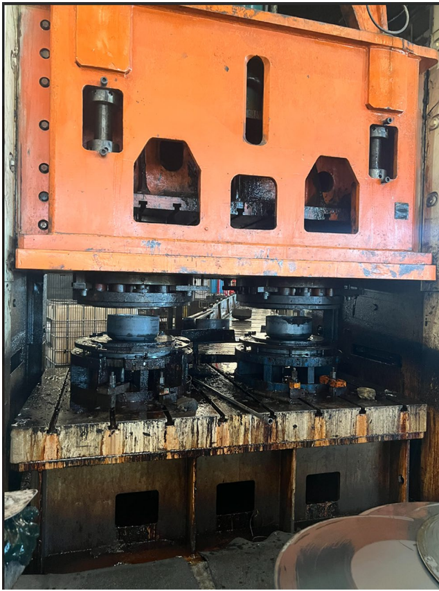
Fig. 1 ERFURT 500-ton eccentric press
