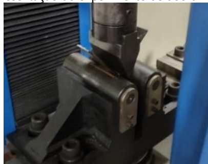
Figura 4 – Representação do experimento de dobramento em V livre.
