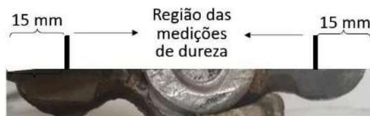
Após medição da dureza em escala Vickers, chegou-se aos resultados indicados na Fig. 10 realizados ao longo de 25 pontos distribuídos linearmente ao longo do perfil das amostras.
