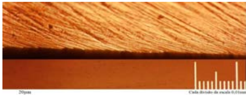
Figura 5 Micro serrilhado do fio de uma faca em aço SAE 1095 laminado comercial, na sua condição inicial.
