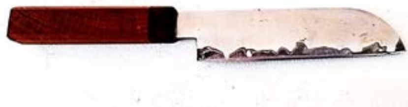
Figura 9 Faca em aço liga proposta contendo SAE 1095 e carbeto de tungstênio na parte do gume e SAE 316L na parte externa.
