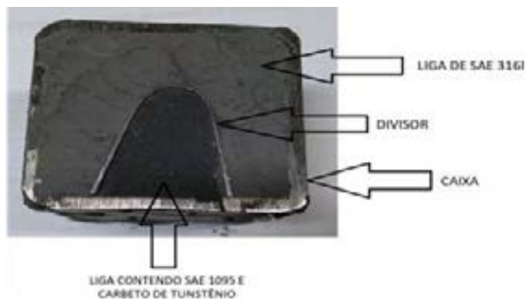
Figura 1 Caixa de damasco com o preenchimento de pós metálicos.
