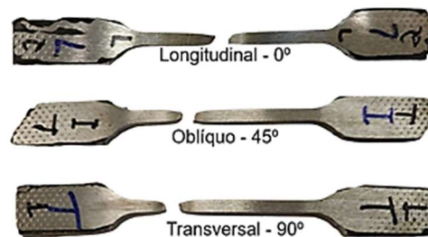
Figura 8: Fratura dúctil do CP, caracterizada pelo ângulo de ruptura (45° aprox.) e pela estricção visível
