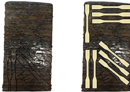
Figura 4. Disposição de corte dos corpos de prova para ensaio de tração
