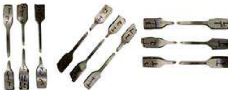
Figura 5: Fratura dúctil dos CPs, caracterizada pelo ângulo de ruptura (45° aprox.) e pela estrição visível.
