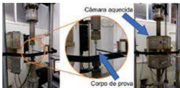
Figura 4: Máquina de ensaio de tração a temperaturas elevadas
