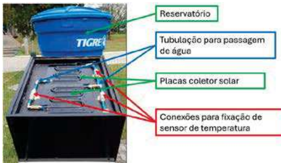
Figura 3: montagem externa do coletor solar
