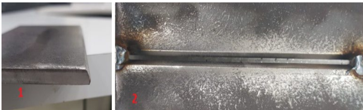
Figura 2. Preparação do corpo de prova: 1:chanfro de 30°; 2: união corpos de prova para soldagem.
