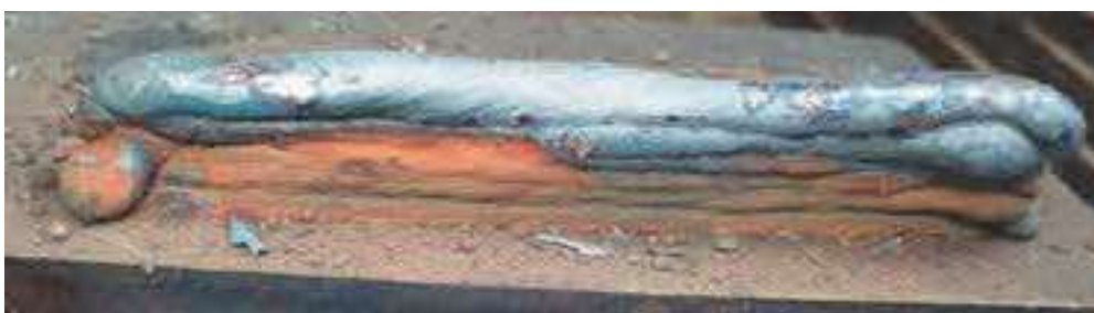
Figura 3: Parede obtida por MADA duplo arame.
