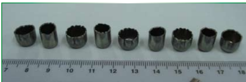
Fig. 9 – Estampagem do copo em dois estágios para o aço inox 304
