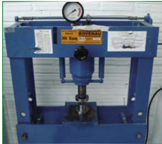
Fig. 4 – Equipamento utilizado para estampagem do copo
