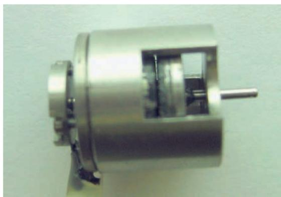
Fig. 2. Micro-motor de passo com 10 mm de diâmetro [18].
