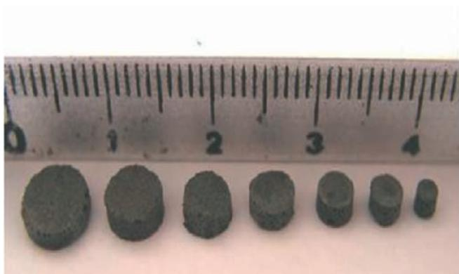
Fig. 3. Camadas de NdFeB produzidas por “Screen-printing” [18].
