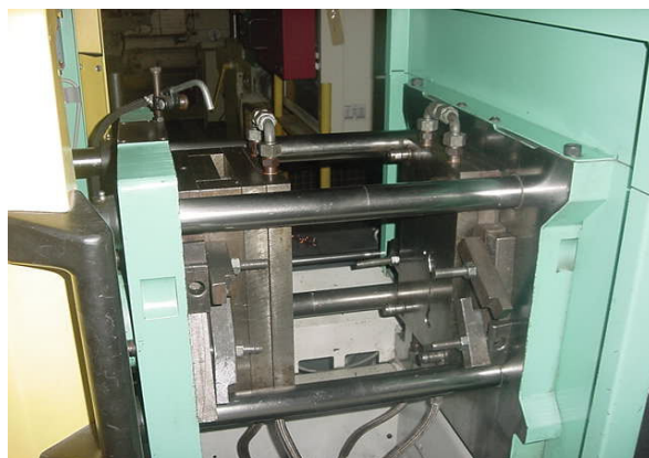
Figura 3 - Matriz de Injeção do corpo de prova escalonado montada na injetora.
