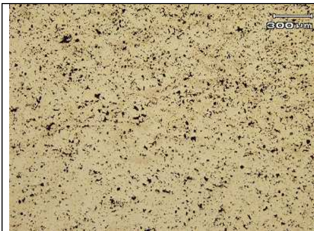
Figura 12: Amostra sinterizada de M2 com 0,3% de bismuto (100 X.)
