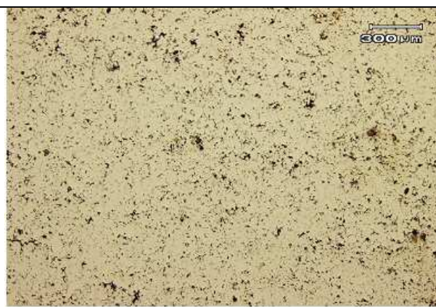
Figura 11: Amostra sinterizada de M2 com 0,1% de bismuto (100X).
