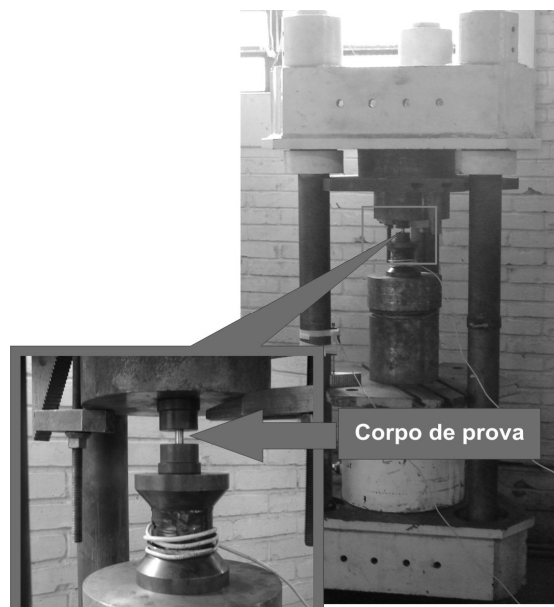
Figura 5. Prensa hidráulica utilizada no ensaio de compressão.
