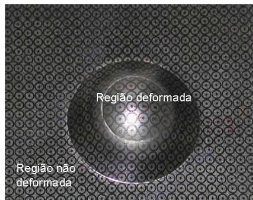
**Figura 5.** Corpo de prova gravado com malha circular, com regiões deformadas e não deformadas.<sup>(7)</sup>
