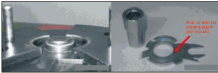
Figura 15 - Matriz de embutimento e peça produzida
