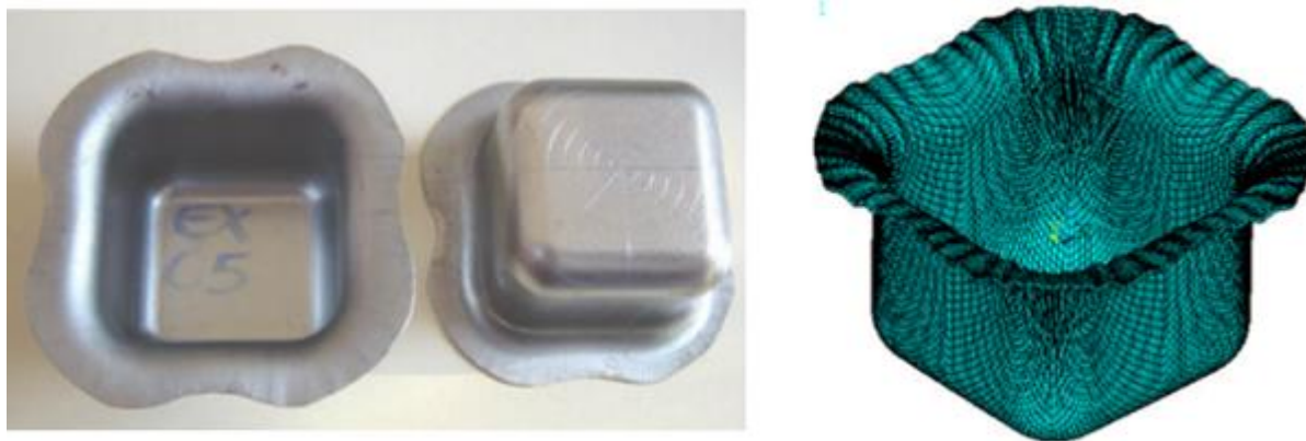
Figura 1 – Representação da caixa estampada (a) e da sua modelagem em 3D empregada na simulação numérica (b)
